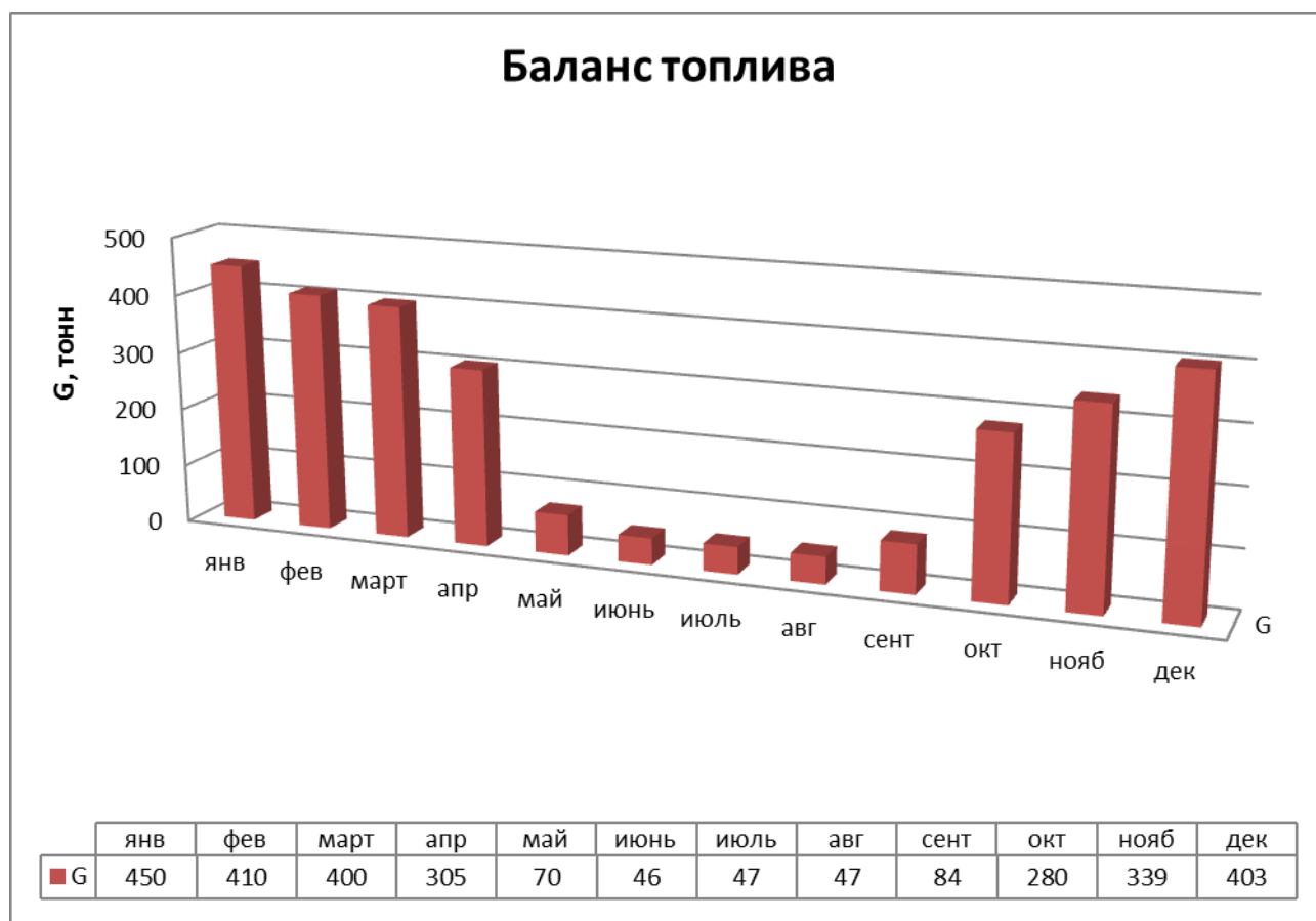
Рисунок 1.8.1 – Топливный баланс поселковой котельной
