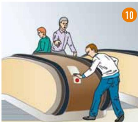
10 Попросите окружающих сообщить дежурному по станции о случившемся. В экстренном случае попросите остановить эскалатор при помощи ручки «Стоп», которая находится на балюстраде в нижней и верхней частях эскалатора.
